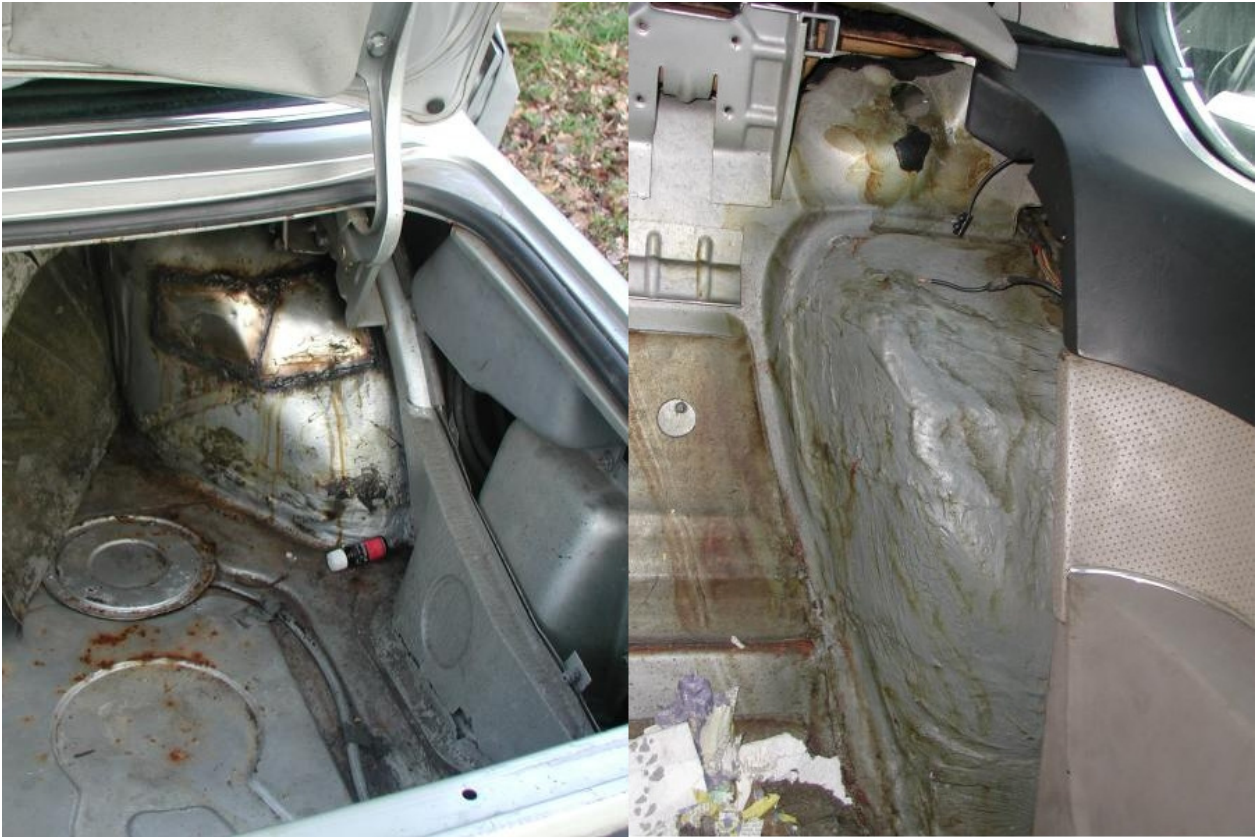
Notdürftig reparierte Radhäuser eines 78er 633CSi
