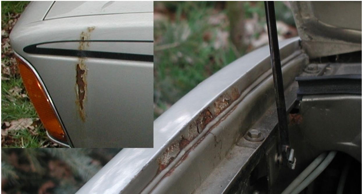
Sehr häufiges Schadensbild beim E24: Durchgerosteter Stehfalz des vorderen Kotflügels. Kleines Bild: Auch andere Bereiche des Kotflügels rosten gerne.
