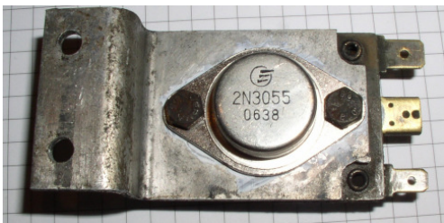
Hat mit Temperaturproblemen zu kämpfen: Transistor der Lüftungssteuerung
