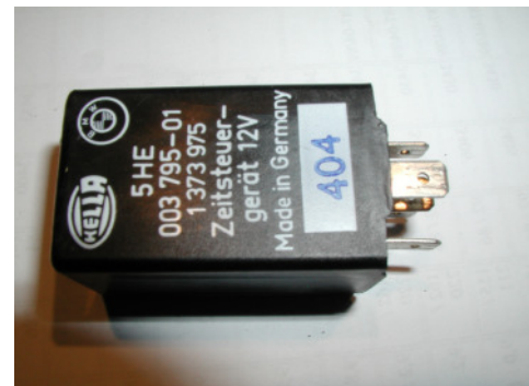
Ebenfalls ein unzuverlässiger Zeitgenosse: Das Steuergerät der Innenlichtverzögerung
