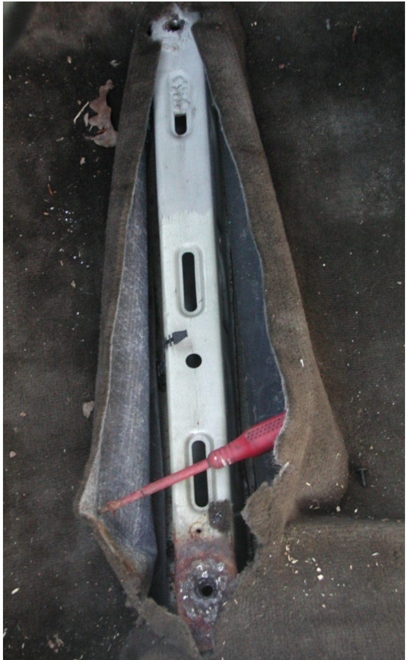
Reparaturversuch an einer herausgebrochenen Sitzverankerung
